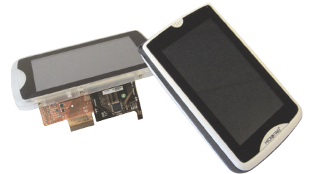
PCAP sensor og front design/integration
